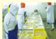
② 砂と殻の除去 パブリング(泡)洗浄等(4回)と目視による厳重なチェック(4回)が行なわれる。
